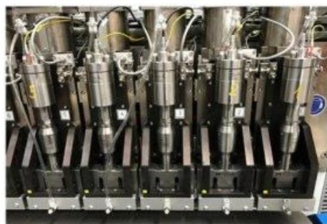
Die aus elektrischen Signalen erzeugten mechanischen Schwingungen werden durch einen Booster und die Sonotroden in die zu verbindende Bahn eingeleitet.
